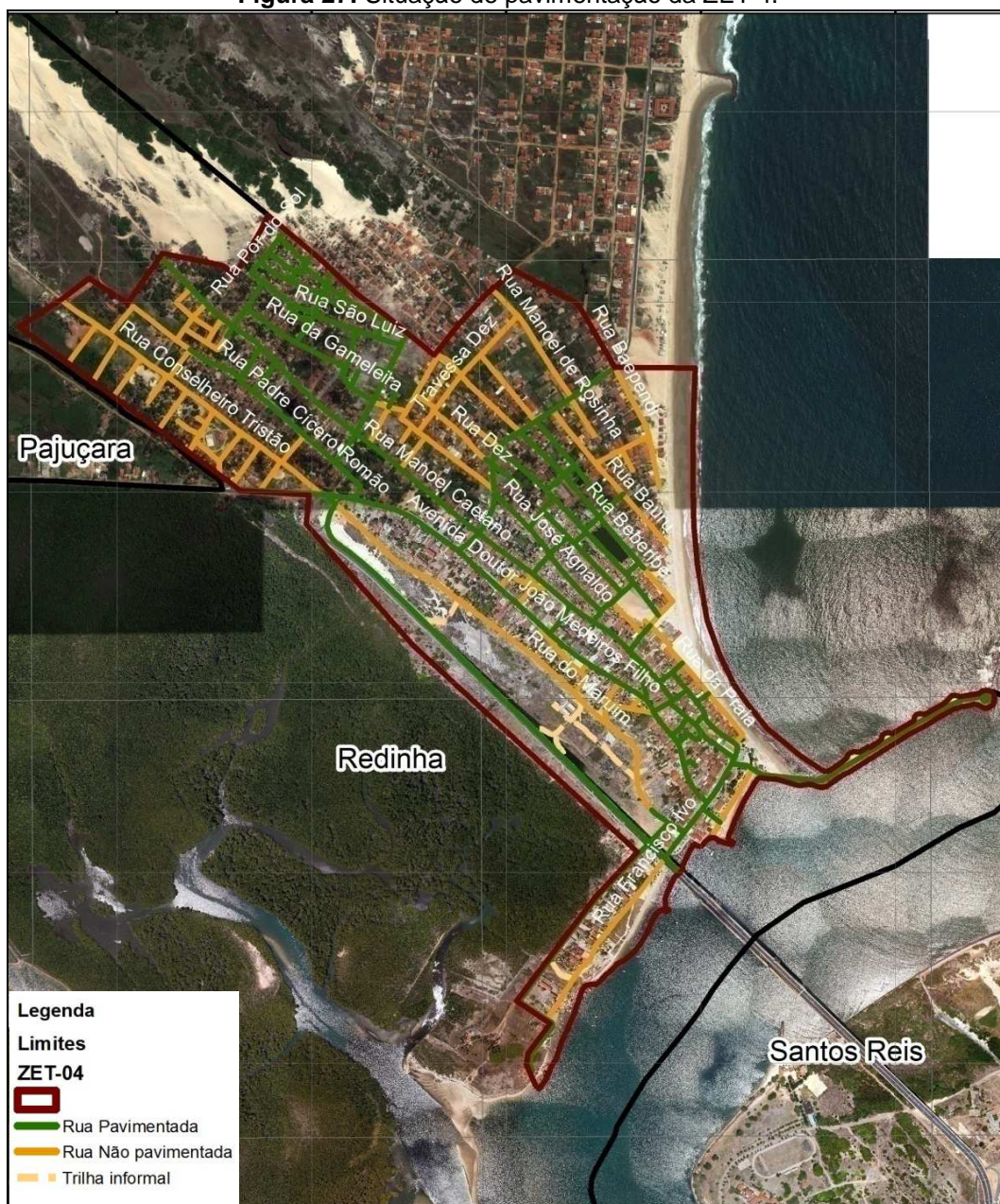
Figura 27: Situação de pavimentação da ZET 4.
